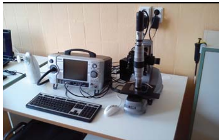
Obrázek 2a. Přístrojové vybavení vyšetřovny ciliárních funkcí: Digitální videomikroskop se záznamem pohybu vysokorychlostní kamerou – pro naše potřeby používáme vysoce kvalitní obrazový záznam snímání s frekvencí 250–500 snímků/sekundu (Keyence®) s příslušenstvím. Vlevo na snímku přístroj MINO NIOX® s adaptérem pro měření nazálního NO a filtrem
