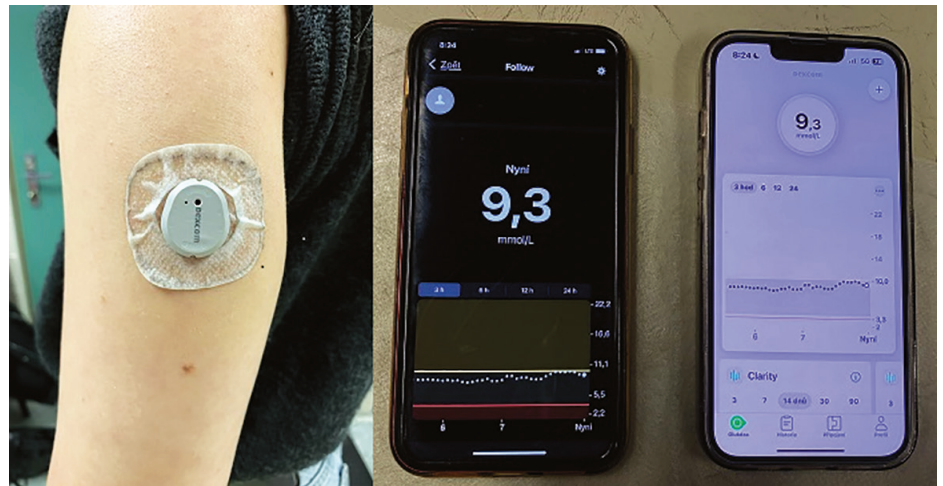
Obr. 1. CGM (senzor kontinuální monitorace glykemie) a spárované mobilní aplikace pacienta s rodičem
